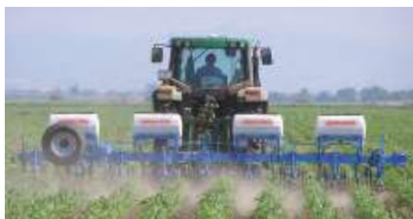
Cadru rigid TIP 5" - 8 rânduri cu 70 cm distanță între rânduri la lucru
