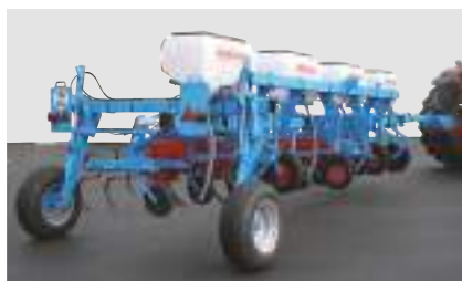
Cadru rigid TIP 5" - 8 rânduri cu 70 cm distanță între rânduri, în timpul transportului
