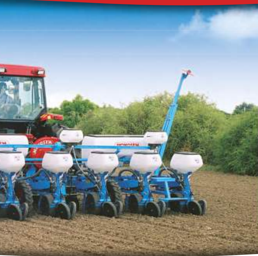
Cadru fix Monobară pentru însămânțare pe 4 rânduri (distanța dintre rânduri de 75 cm)
