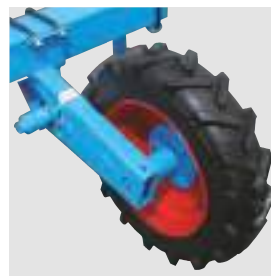
Bloc roți standard cu anvelopă de 6,5x80x15
