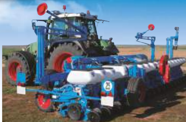
Cadru de cuplaj pentru 18 rânduri (distanța dintre rânduri de 45 cm)
