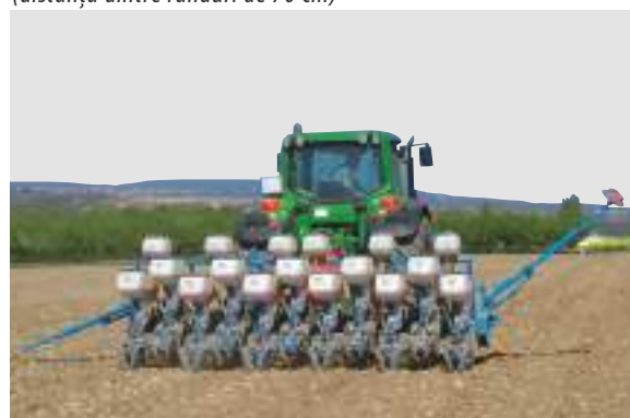
Cadru fix Monoblock pentru o însămânțare pe 11 rânduri (distanța dintre rânduri de 37,5 cm sau pentru una pe 6 rânduri la o distanță între rânduri de 75 cm)
