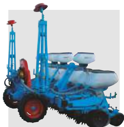
Cadru Monoblock long off-set mare și bloc de roți frontale permite o distanță redusă între rânduri de 37,5 cm.
