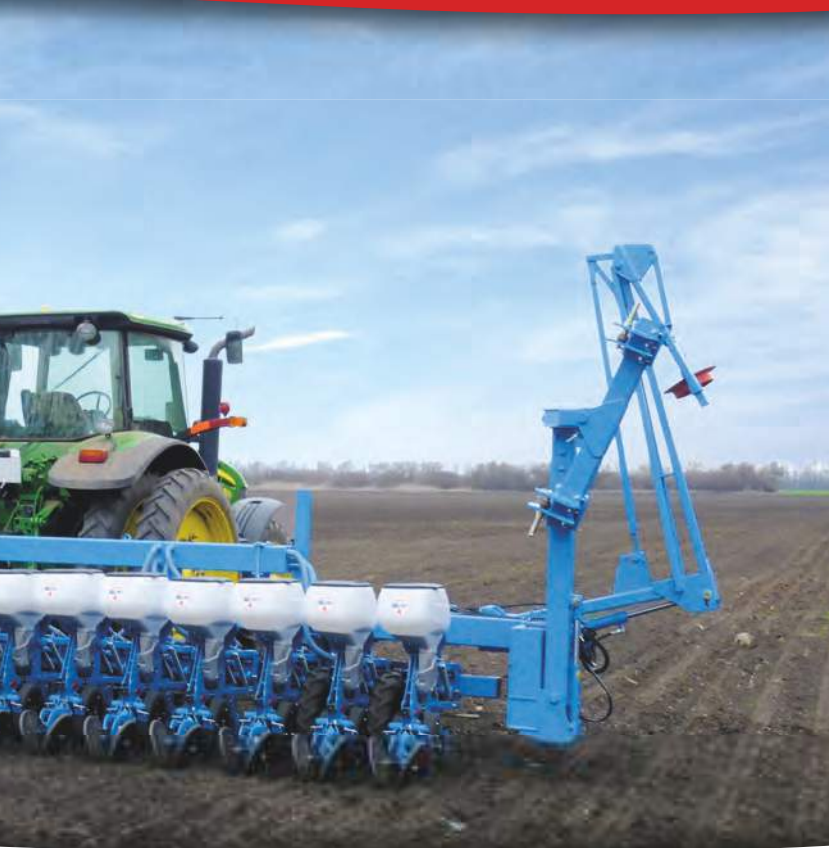
Cadru de cuplaj pentru 18 rânduri (distanța dintre rânduri de 45 cm)
