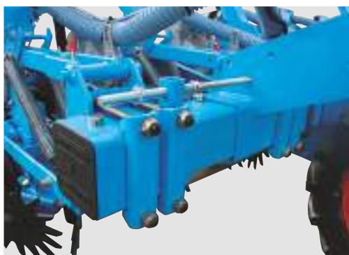
Elementele de blocaj de pe sistemul telescopic permit o stabilire perfectă a distanțelor dintre rânduri precum și o pliere adecvată a echipamentului semănătorii.
