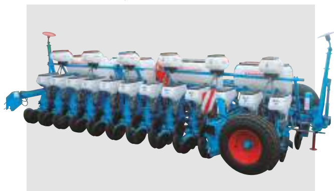
Cadru fix tip Bară dublă pentru o însămânțare pe 12 rânduri (distanța dintre rânduri de 45 cm) prevăzut cu cârucior de transport longitudinal.
