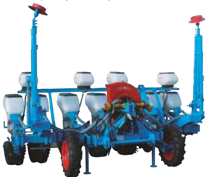
Semănătoare cu bloc de roți frontale pentru însămânțare cu o distanță redusă între rânduri (până la 37,5 cm) sau pe teren pietros.
