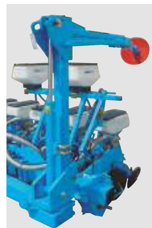
Cadru pliabil cu Bară dublă pentru o însămânțare pe 12 rânduri (distanța dintre rânduri de 45 cm)
