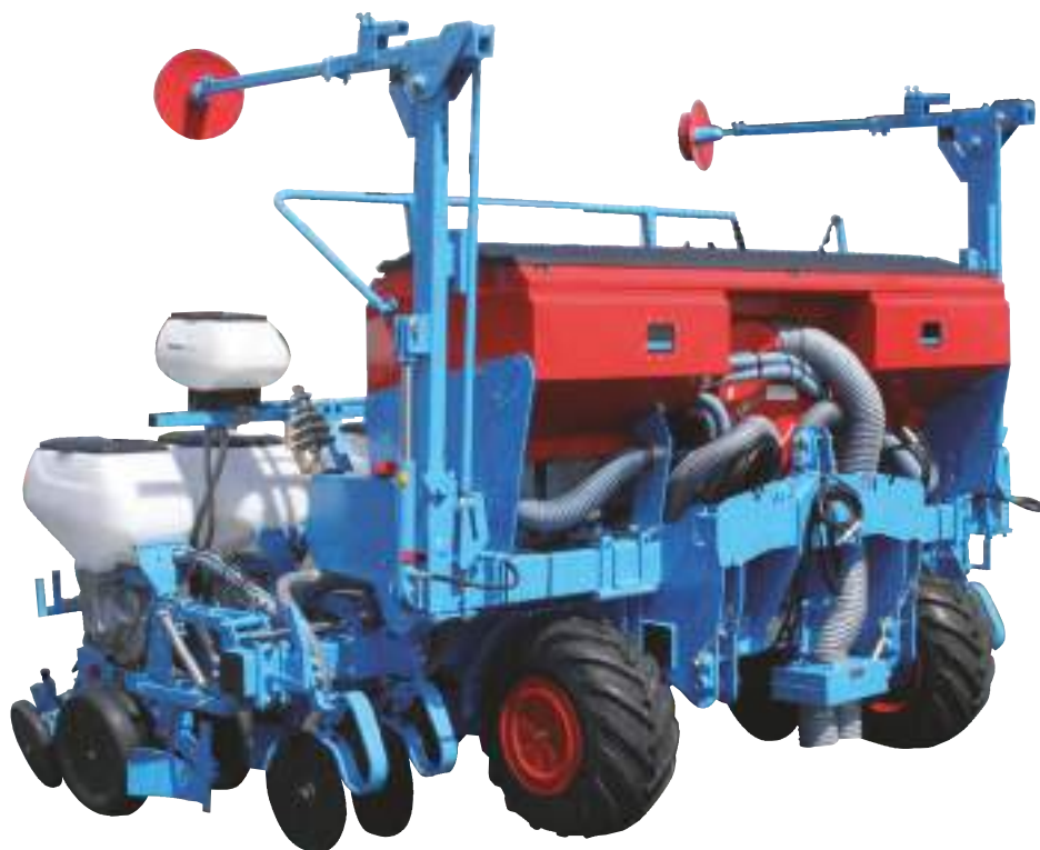
Semănătoare cu cadru Monoblock2 Confort pe 6 rânduri cu buncăr de fertilizare de 680 L și sistem Microsem
