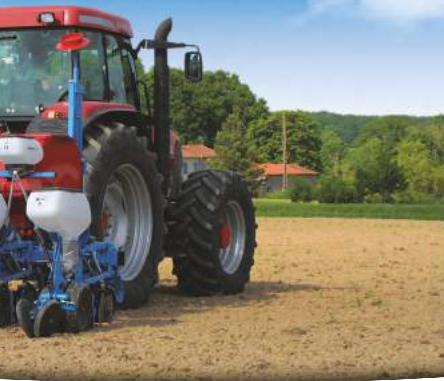
Cadru telescopic simplu Monoblock pentru o însămânțare pe 6 rânduri (distanța dintre rânduri de 75 cm)
