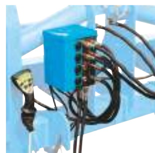
Selectorul electric (necesar 1 DA / 4 funcții) este disponibil opțional și necesită doar o singură valvă cu dublu efect pentru controlul aceluiași număr de funcții.
