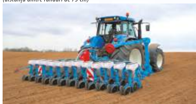
Cadru pliabil cu Bară dublă pentru o însămânțare pe 12 rânduri (distanța dintre rânduri de 45 cm)
