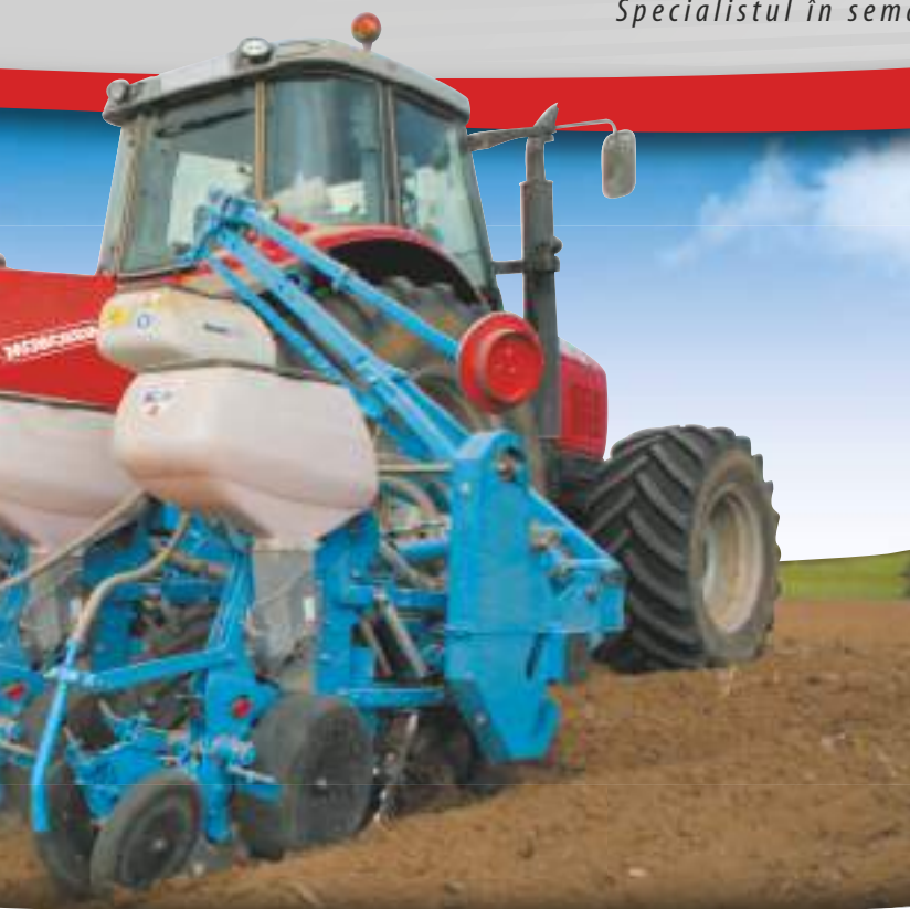
Cadru flotant TFC pe 8 rânduri (75 cm distanță între rânduri)
