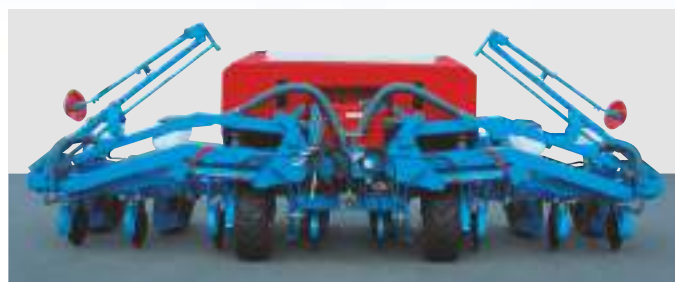
Cadru pliabil TFC fix pe 8 rânduri (75 cm distanță între rânduri)
