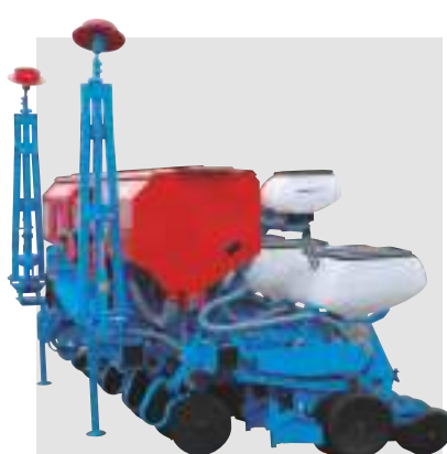
Cadru Monoblock 260 long off-set permite echiparea cu un buncăr de fertilizare „de mare capacitate”.
