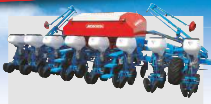
Cadru flotant TFC pe 8 rânduri (75 cm distanță între rânduri)
