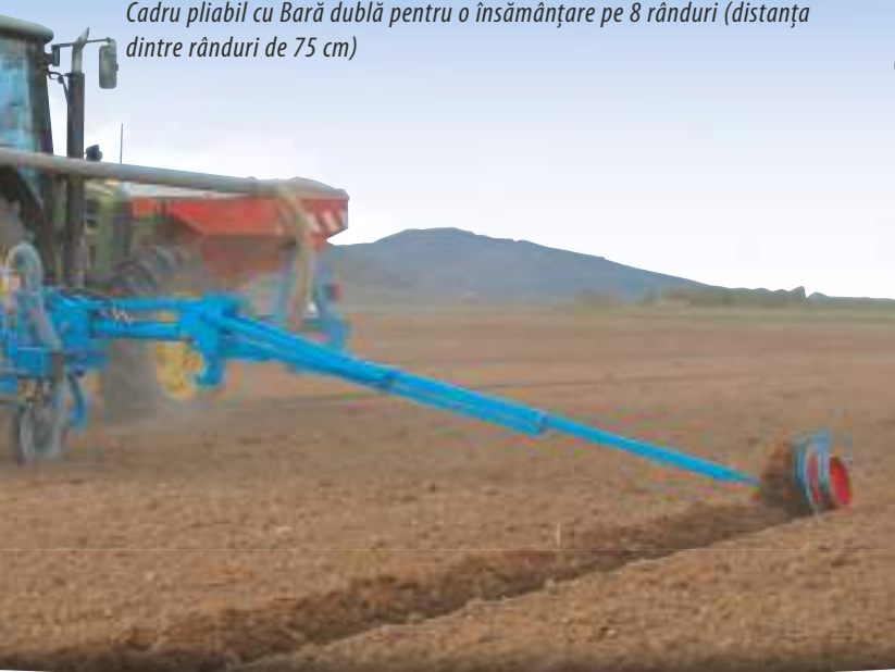
Cadru pliabil cu Bară dublă pentru o însămânțare pe 8 rânduri (distanța dintre rânduri de 75 cm)
