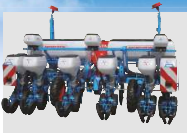
Cadru telescopic simplu Monoblock pentru o însămânțare pe 6 rânduri (distanța dintre rânduri de 75 cm)
