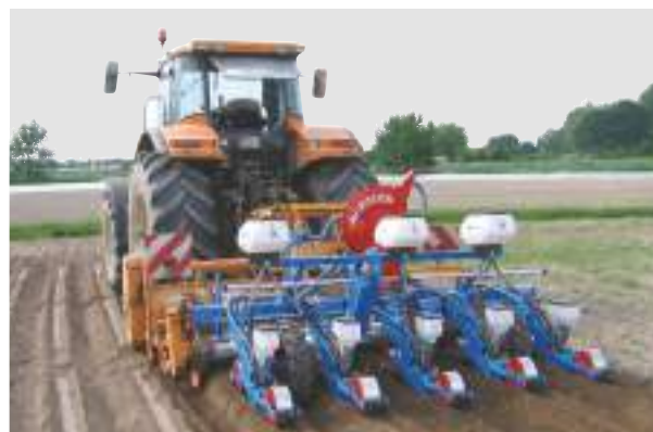
Semănătoare MS A - cadru rigid cu o bară - 5 rânduri cu Microsem
