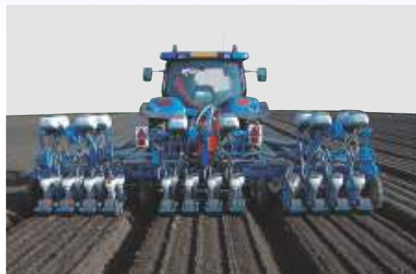
Semănătoare MS D2 - cadru pliabil dublu - 3 x 4 rânduri cu Microsem
