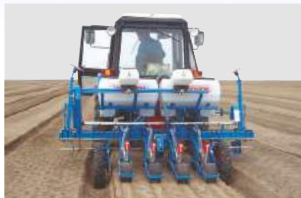
Semănătoare MS A - cadru rigid monobloc - 4 rânduri cu fertilizator și Microsem
