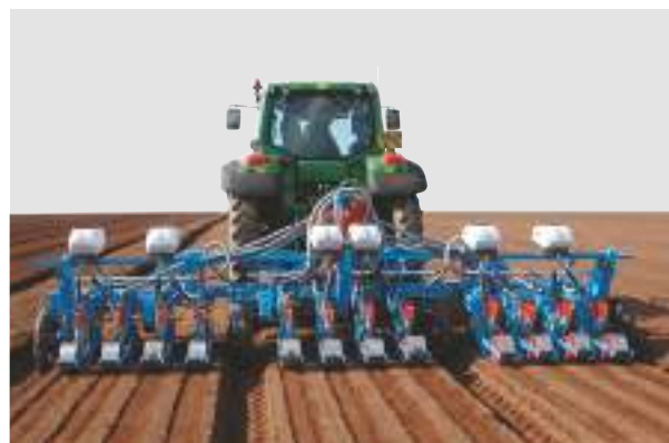
Semănătoare MS C - cadru pliabil dublu - 3 x 4 rânduri cu Microsem
