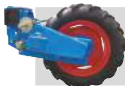
Cutie de viteze integrată în unitatea roții Distanța minimă între rânduri (1): 43 cm
